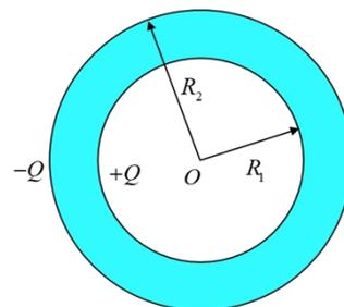
4. (10 分) 一根同轴线由半径为  $R_1$  的圆柱导体和套在它外面的内半径为  $R_2$ 、外半径为  $R_3$  的同轴导体圆筒组成。  $R_1$  和  $R_2$  中间充满磁导率为  $\mu$  的各向同性均匀非铁磁绝缘材料，如图。传导电流  $I$  沿导线向上流去，由圆筒向下流回，在它们的截面上电流都是均匀分布的。求同轴线内外的磁感强度大小  $B$  的分布。
