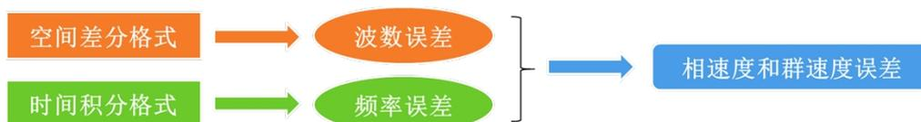
相速度是等相位面移动的速度, 而群速度是波包移动的速度。当相速度与群速度相一致的波称为非频散波, 否则称为频散波。
